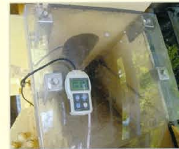
5ヶ月後のカバー内側の計測 内気温31.4℃ 内部湿度61.3%
