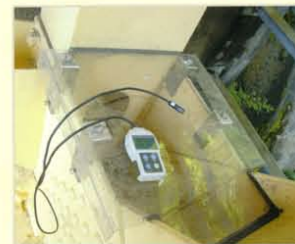
5ヶ月後のカバー外側の計測 外気温31.6℃ 湿度62.5%
